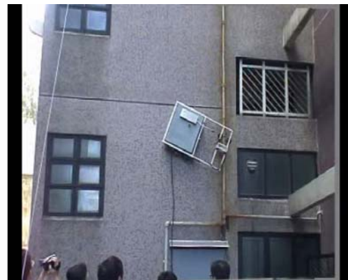
(d) Manual align the robot to the pipe
