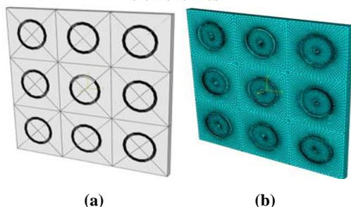
Fig. 5 a) multi fiber 3x3 square array RVE model. b) finite element mesh
