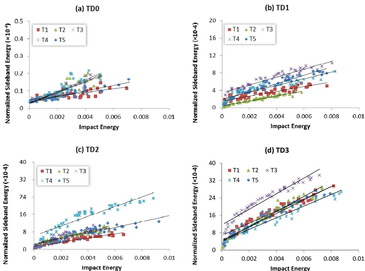
Fig. 2. Nonlinear ultrasonic modulation technique test results: (a) TD0, (b) TD1, (c) TD2, (d) TD3
