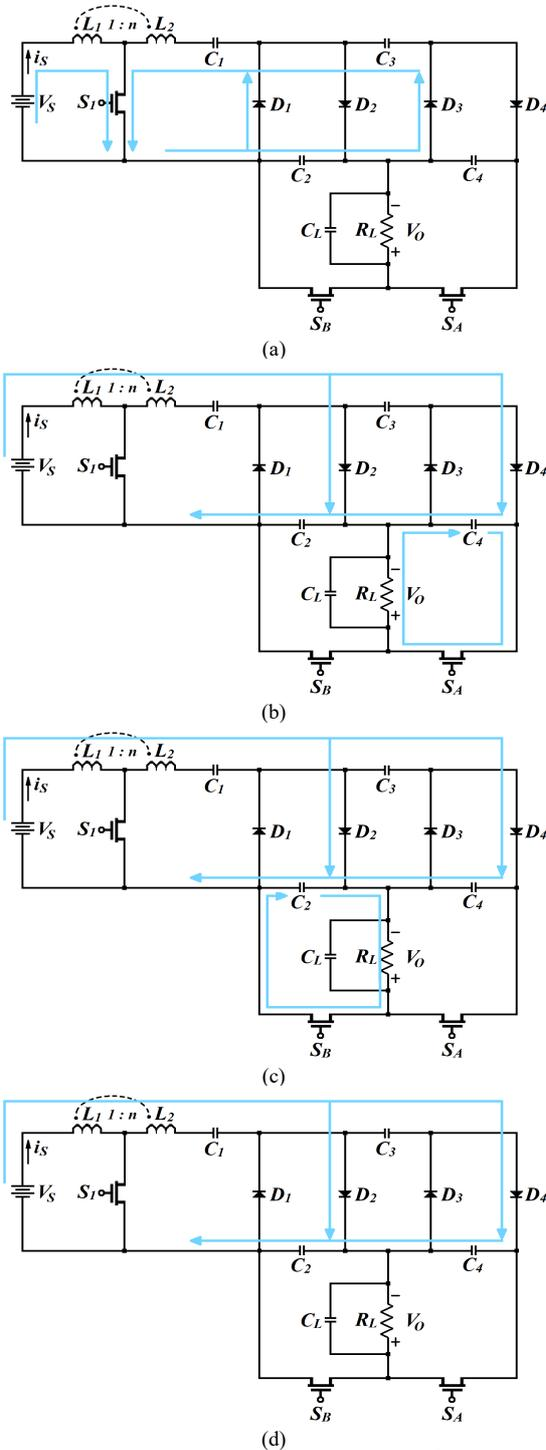
Fig. 3. Topologies in (a) Phase I, (b) Phase II ( $S_A$ : ON), (c) Phase II ( $S_B$ : ON), (d) Phase II ( $S_A, S_B$ : OFF).
