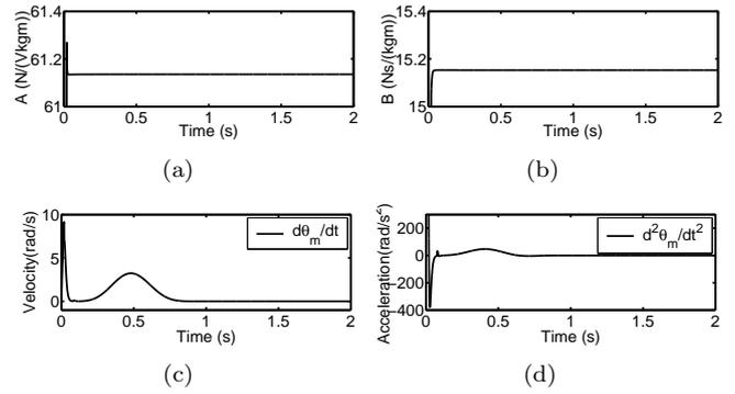
Figure 3: (a) Estimation of  $A$ . (b) Estimation of  $B$ . (c) Estimation of  $\dot{\theta}_m$ . (d) Estimation of  $\ddot{\theta}_m$
