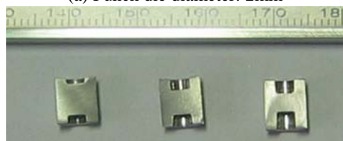
(b) Punch die diameter: 3mm
