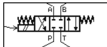
Fig. 8. Valve scheme.
