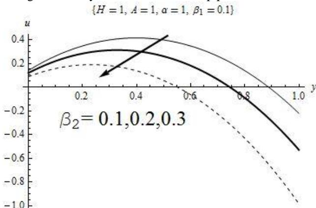
Fig 2: Velocity versus upper wall slip parameter
